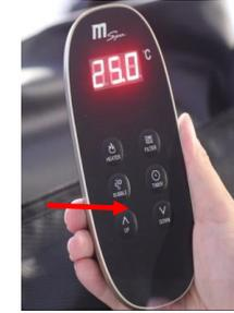
4. Drücken Sie den "BUBBLE"-Knopf lange (min. 2 Min bis sich der Zeiger im gelben Bereich befindet). **Wenn nicht lange genug gedrückt wird, wird die Bubble-Funktion automatisch gestoppt, um zu verhindern, dass sie nicht zu sehr aufgeblasen wird.**
