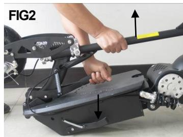
2. Um den Roller aufzuklappen halten Sie mit einer Hand am Hebel und drücken mit der anderen die Lenkstange nach oben bis diese einrastet. (FIG.2)
