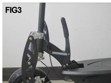
3. Überprüfen Sie ob der Klappmechanismus eingerastet ist. (FIG.3)
