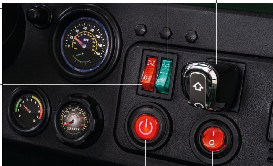
Wechsel zwischen 2x2- und 4x4-Antrieb
