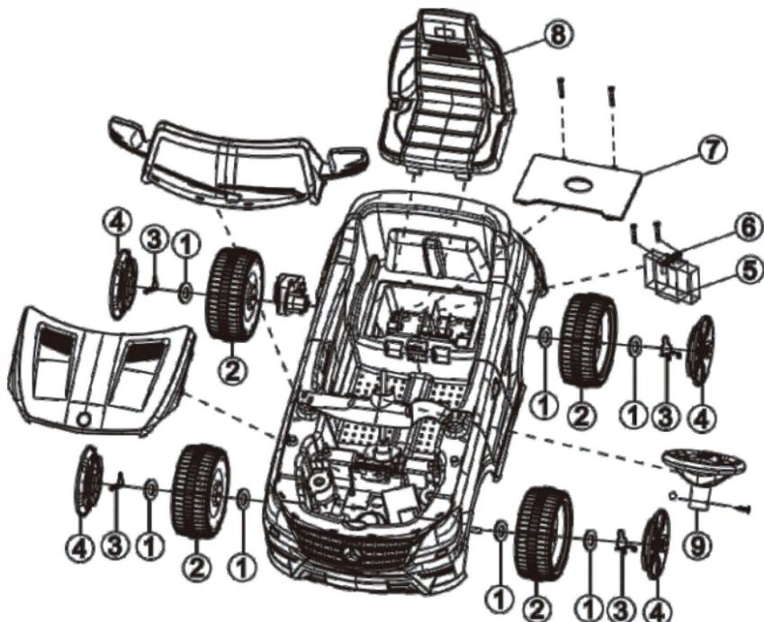
1. Montage der Vorderräder: Zuerst die Dichtung **(1)** auf die Vorderachse montieren. Dann das Schmiermittel verteilen und das Rad **(2)** auf die Achse schieben. Anschließend eine neue Dichtung **(1)** anbringen und mit einem Halteclip **(3)** verriegeln. Man kann auch mehr Dichtungen verwenden wenn das Rad noch zu viel Spiel hat.
