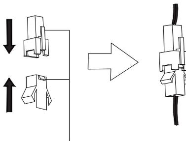
Diese beiden Teile müssen sich beim Verbinden auf derselben Seite befinden.
