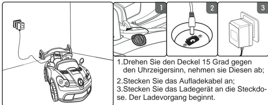
1. Drehen Sie den Deckel 15 Grad gegen den Uhrzeigersinn, nehmen sie Diesen ab;
