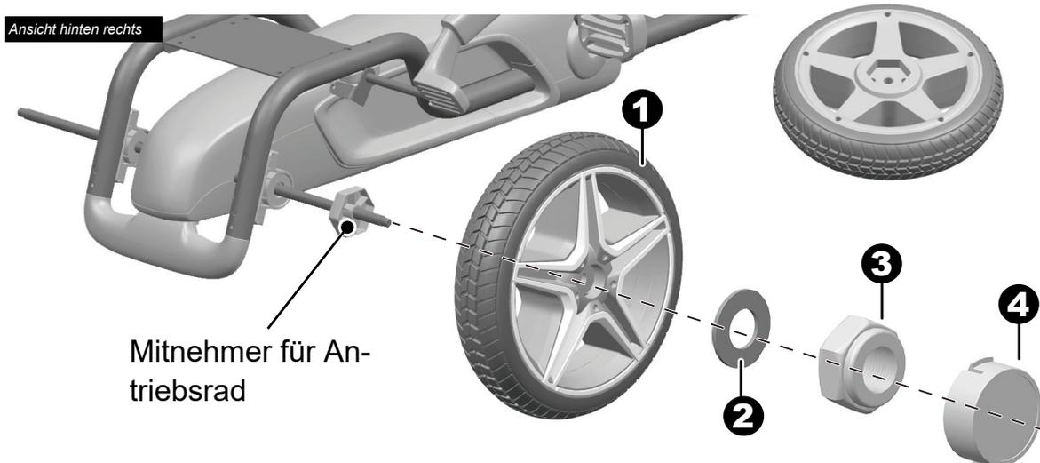
1. Stecken Sie die Unterlegscheibe  $\varnothing 12$  auf die Hinterachse.
