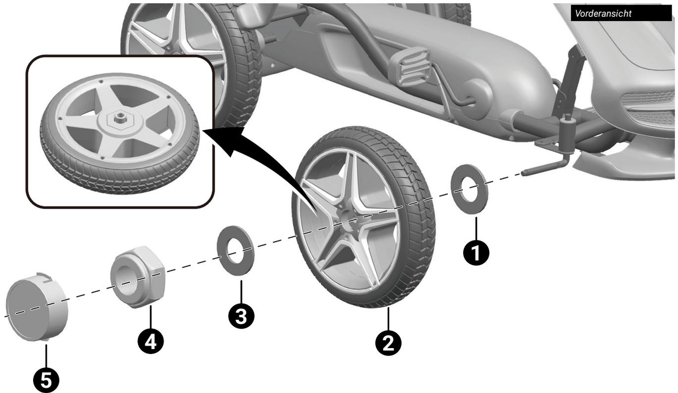
1. Stecken Sie eine Unterlegscheibe  $\varnothing 12$  auf den rechten Achsschenkel der Vorderachse.
