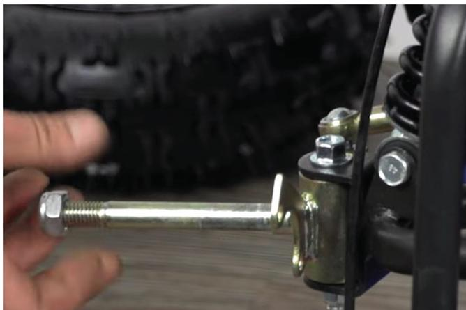
Stecken Sie das Rad mit der Bremsscheibe nach innen auf und sichern Sie es mit der zuvor gelösten Sicherungsmutter.
