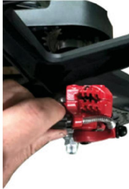
Oder mit einem 5 mm-Inbussschlüssel den Bremszug lösen und den Bremssattel so einstellen, dass die Zuglänge vom Bremssattel bis zur Säule 30 mm beträgt.
