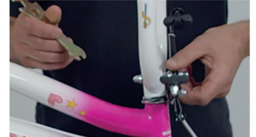
Nun bringen Sie das Distanzstück wieder an und führen die Schraube durch die vorgesehene Bohrung. Anschließend wird das zweite Distanzstück, danach die Unterlegscheibe angebracht und mit der Sicherungsmutter wieder fest angezogen.
