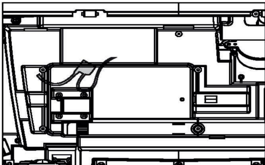
Dieses Fahrzeug ist mit einer selbstrückstellender Sicherung ausgestattet. Das Fahrzeug stoppt plötzlich während der Fahrt, wenn der maximale Nennstrom überschritten wird, wodurch die Sicherung ausgelöst wird.
