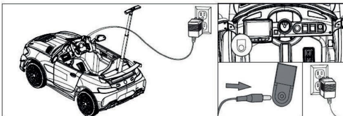
Wenn das Auto langsamer geworden ist, muss es zwischen 8 und 12 Stunden aufgeladen werden, maximal 20 Stunden.
