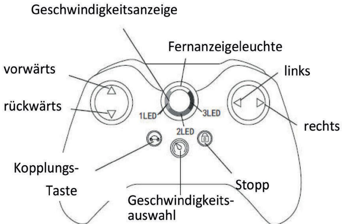
1. Bevor Sie die Fernbedienung zum ersten Mal verwenden, müssen Sie sie wie folgt mit dem Auto verbinden:
