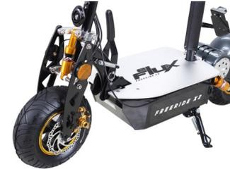
1. Nehmen Sie vorsichtig den Roller aus der Verpackung. Montieren Sie das vordere Rad. Die lange Hülse muss links und die kurze Hülse rechts vom Rad so das sich das Rad zwischen den Hülzen befindet und ziehen die Schraube fest an.
