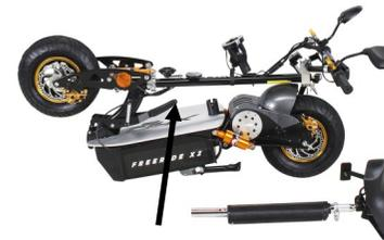
2. Um den Roller aufzuklappen halten Sie mit einer Hand am Hebel und drücken mit der anderen die Lenkstange nach oben bis diese einrastet.
