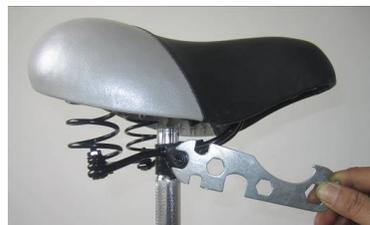
11. Montieren Sie den Sitz und ziehen die Schrauben mit den mitgelieferten Schlüssel fest.
