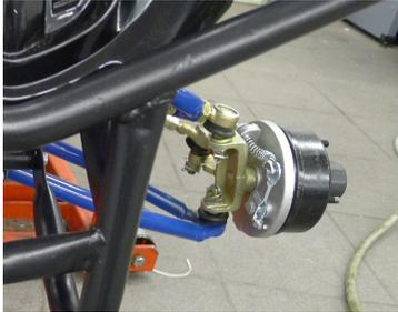
Ist dies geschehen muss die Bremstrommel auf die Vorderachse gesteckt werden. Hierbei muss beachtet werden, dass die Trommel in der Führung sitzt. Dann diese durch die Mutter sichern und die Mutter mit Splint versehen und diesen dann umbiegen. Achtung! Die Mutter darf nur so weit angezogen werden bis ein leichter Widerstand beim Drehen bemerkbar ist, sonst könnten die Lager beschädigt werden. Um die Sicherheit
