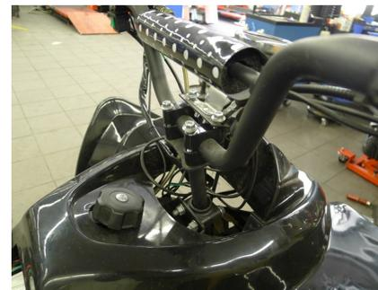
3. Legen Sie den Tacho (ggf. auch die Richtungsanzeige) auf die oberen Lenkerklammern, dann schrauben Sie den Lenker fest mithilfe der Schrauben. (Achten Sie darauf, dass Sie die Schrauben kreuzweise und gleichmäßig anziehen; auch sollte Sie sich versichern, dass der Lenker den richtigen Winkel hat (Abb. links)).
