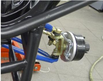
Ist dies geschehen muss die Bremstrommel auf die Vorderachse gesteckt werden. Hierbei muss beachtet werden, dass die Trommel in der Führung sitzt. Dann diese durch die Mutter sichern und die Mutter mit Splint versehen und diesen dann umbiegen. Achtung! Die Mutter darf nur so weit angezogen werden bis ein leichter Widerstand beim Drehen bemerkbar ist, sonst könnten
