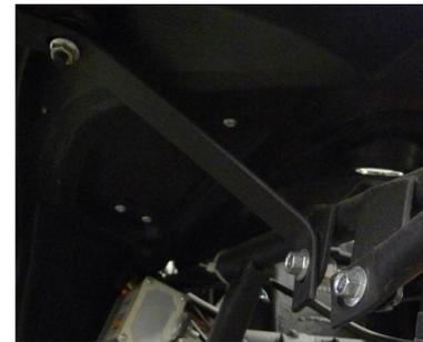
Die beige-lieferten Halter stabilisieren den hinteren Kotflügel. Diese werden vor der Halterung des Gepäckträgers montiert.
