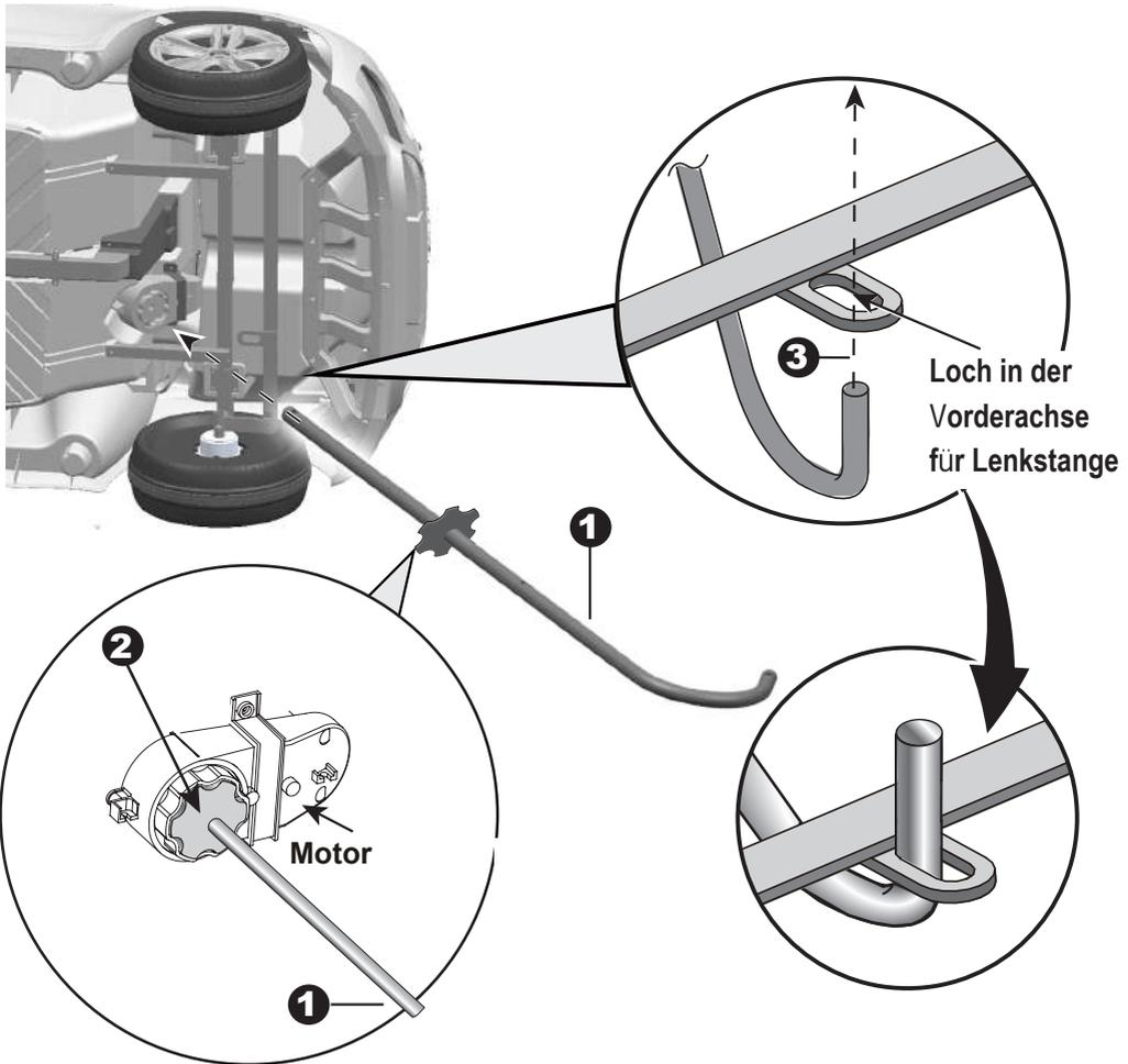
1. Drehen Sie das Fahrzeug auf die Seite. Schieben Sie das gerade Ende der Lenkstange durch den Lenkmotor, bis diese aus der Armatur ragt.
