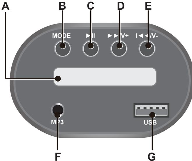
**A. Digitale Spannungsanzeige:** Zeigt den Akkustand an.
