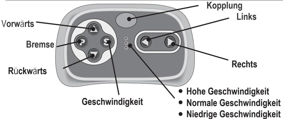
Die Fernsteuerung des Erwachsenen greift sofort und dominiert über die manuelle Steuerung des Kindes im Fahrzeug.
