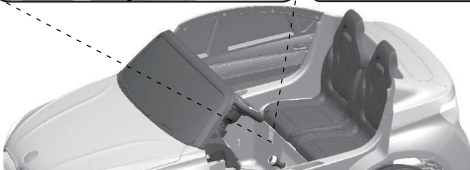
1. Stecken Sie das Ladegerät in das Fahrzeug. Der Anschluss ist unterhalb des Sitzes.
