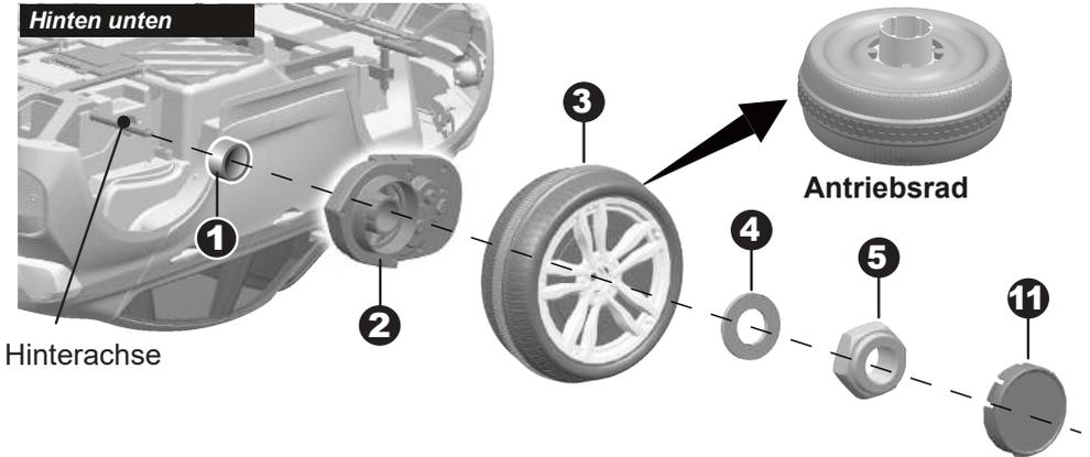
1. Schieben Sie eine Hülse auf die Hinterachse, und anschließend den Motor.
