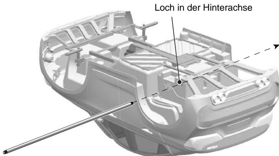
Drehen Sie das Fahrzeug auf den Kopf und führen Sie die Hinterachse gemäß der Abbildung ein.
