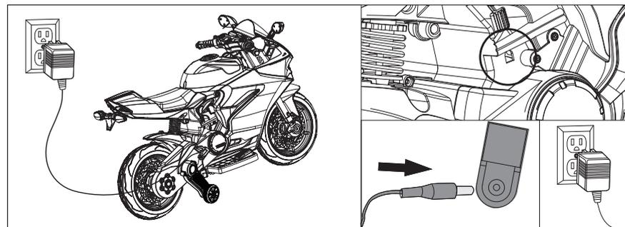
1. Stecken Sie den Stecker des Ladegeräts in die Ladebuchse.
