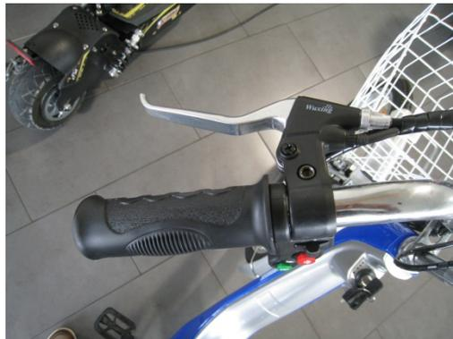
Der in Fahrtrichtung linke Bremsgriff ist für die Hinterradbremse.
