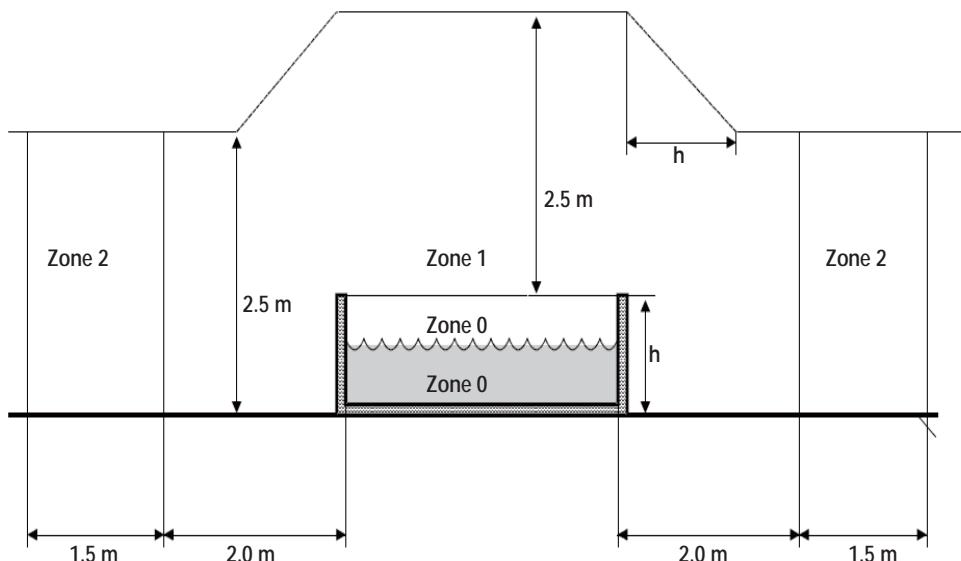
**NOTE** - Les dimensions de la zone de mesure sont limitées par les murs et parois fixes.
