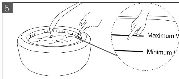
**Achtung:** Der Wasserstand muss mindestens die „Minimum Water Line“ erreichen. Überfüllen Sie den Whirlpool jedoch unter keinen Umständen über die „Maximum Water Line“-Markierung, da dies zu Pumpenschäden führen kann.
