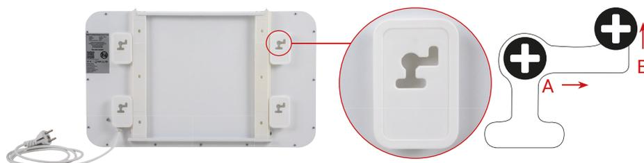
**Vergewissern Sie sich, dass die Schraubenköpfe ordnungsgemäß an den 4 Befestigungspunkten der Heizplatte eingerastet sind, bevor Sie die Heizung loslassen.**
