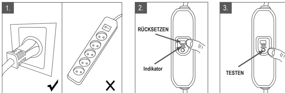
Die PRCD funktioniert nicht an defekten Steckdosen oder Steckerleisten.
