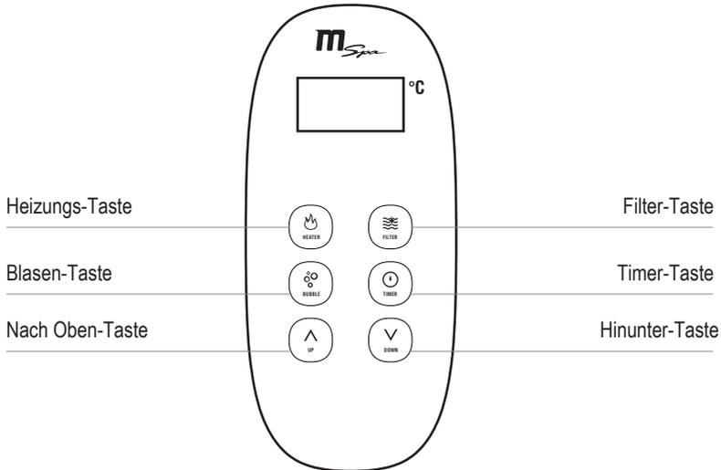
**Hinweis: Temperaturanzeige: Drücken Sie RÜCKSETZEN („Reset“) auf dem Fehlerstromschutzschalter PRCD, der Bildschirm zeigt die aktuelle Temperatur an**
