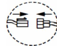
Schließen Sie den Netzteilstecker an
